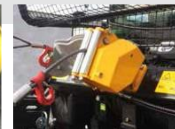
Opcionális csörlővel, kérésre akár 2x 8 tonna
